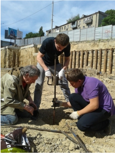
Динамічне зондування ґрунтів малогабаритним ручним зондом. Асп. Я. В. Ульянов зі співробітниками кафедри (2015 р.)
