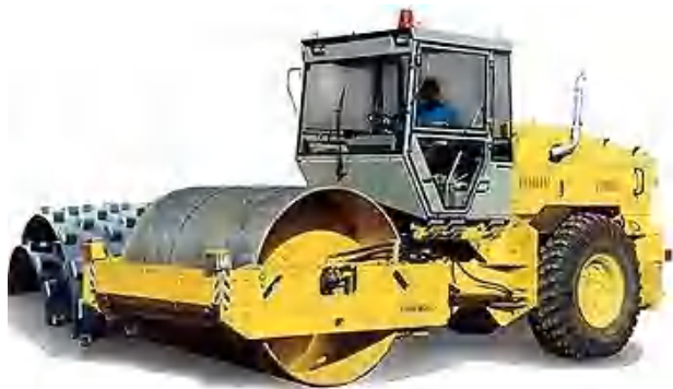
Рис. 4. Коток із змінною оболонкою вальця
