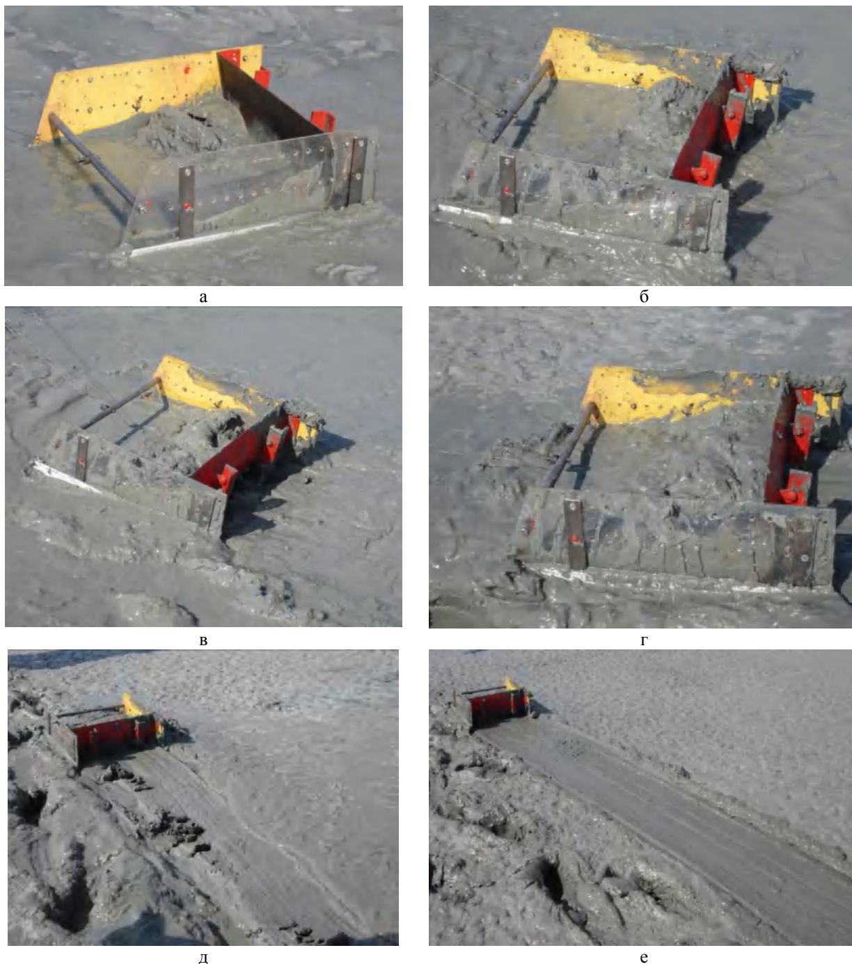
Рис. 5. Дослідження розробки лікувальних грязей моделлю скреперного ковша: а – загальний вигляд моделі; б, в, г – етапи розробки; д, е – наслідки розробки шару пелоїдів.
