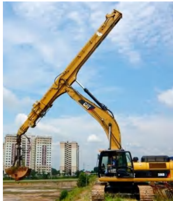
Рис. 8. Екскаватор CAT 336D з телескопічною рукояттю.
