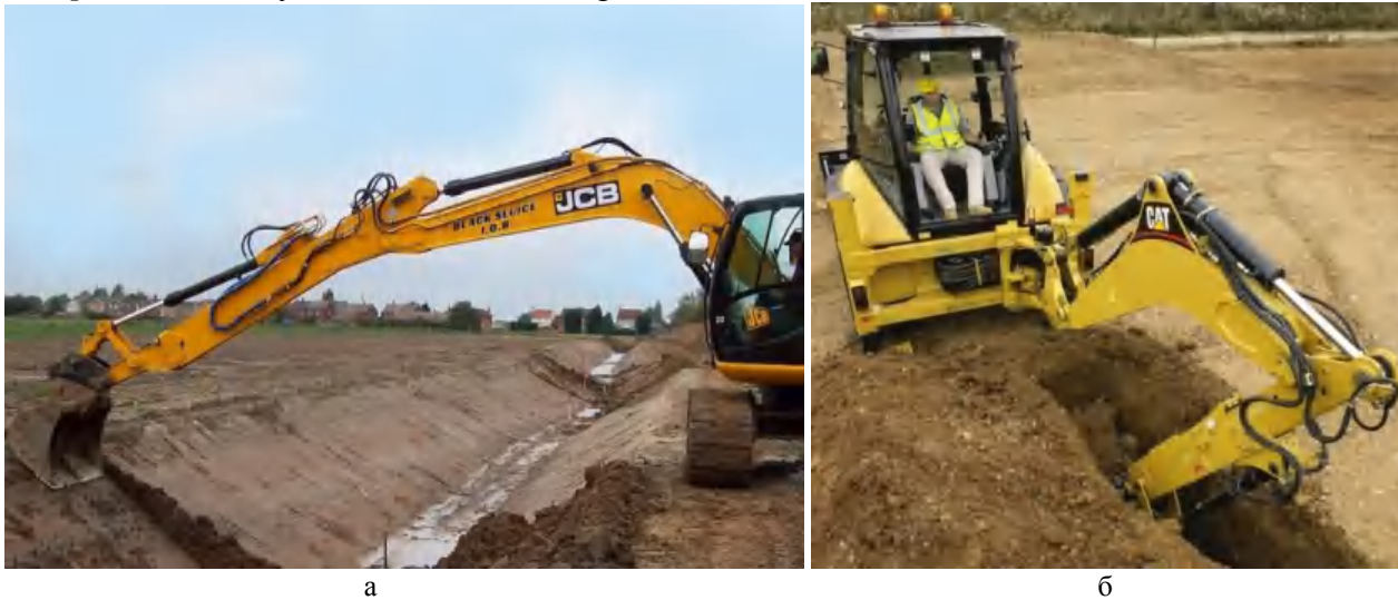
Рис. 7. Екскаватори з телескопічними рукоятями: а – фірми JCB ; б – CAT 444E .
