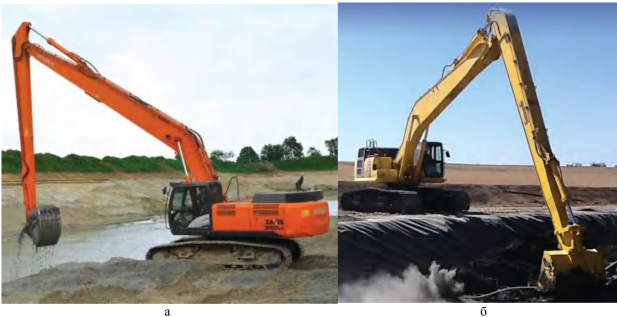
Рис. 3. Екксаватори зі збільшеним РО при виконанні робіт: а – Hitachi ZX 250LC при роботі на розчистці каналу; б – Komatsu PC 240LC-10.
