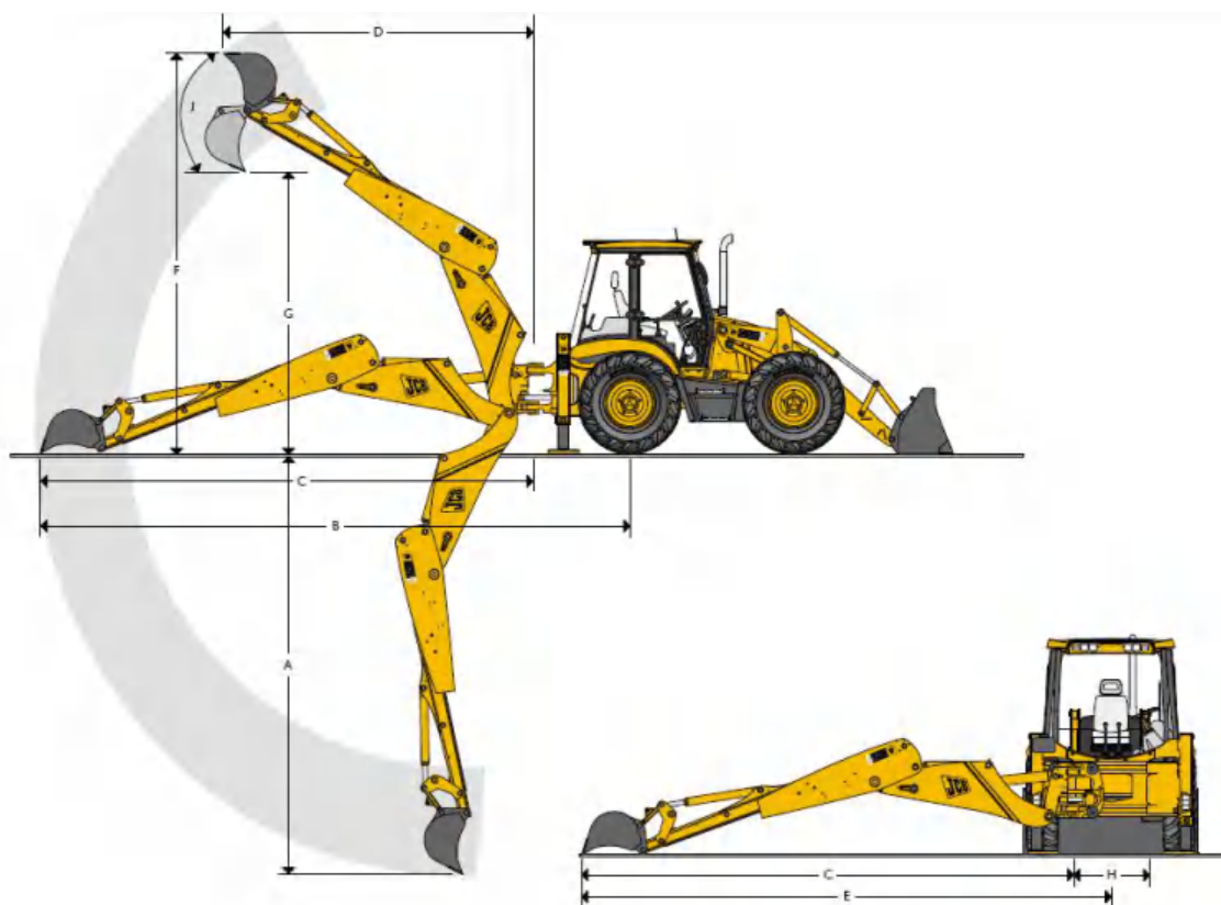
Рис. 6. Экскаватор-навантажувач JCB 3CX з телескопічною рукояттю.
