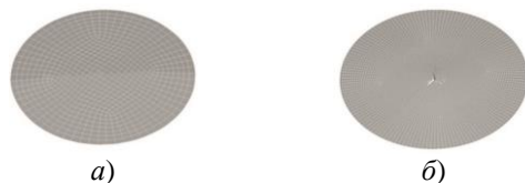
Рис. 2. КЭ модель конической оболочки с N = 768 (а) и N = 3888 (б) / Finite element model of conical shell built of N = 768 (a) and N = 3888 (b) elements
