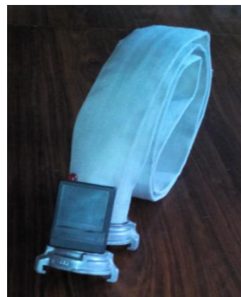
Рис. 4. Пожежний рукав з сигналізатором напруги у складеному вигляді/Fire sleeve with voltage signal in the folded form
