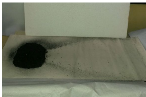
Рис. 3. Зона загрязнения возле модели угольного штабеля /
