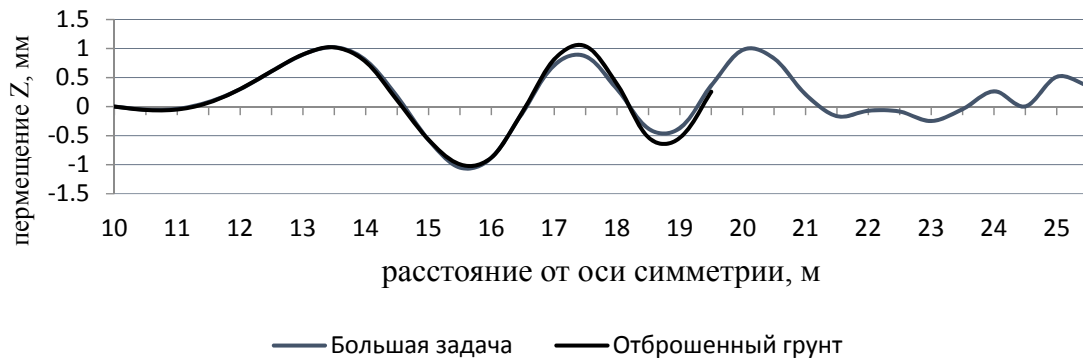
Рисунок 9. График перемещений Z на глубине 8 метров в момент времени 1,5с. Figure 9. Diagram of displacements Z at the depth of 8m at time moment 1,5s.
