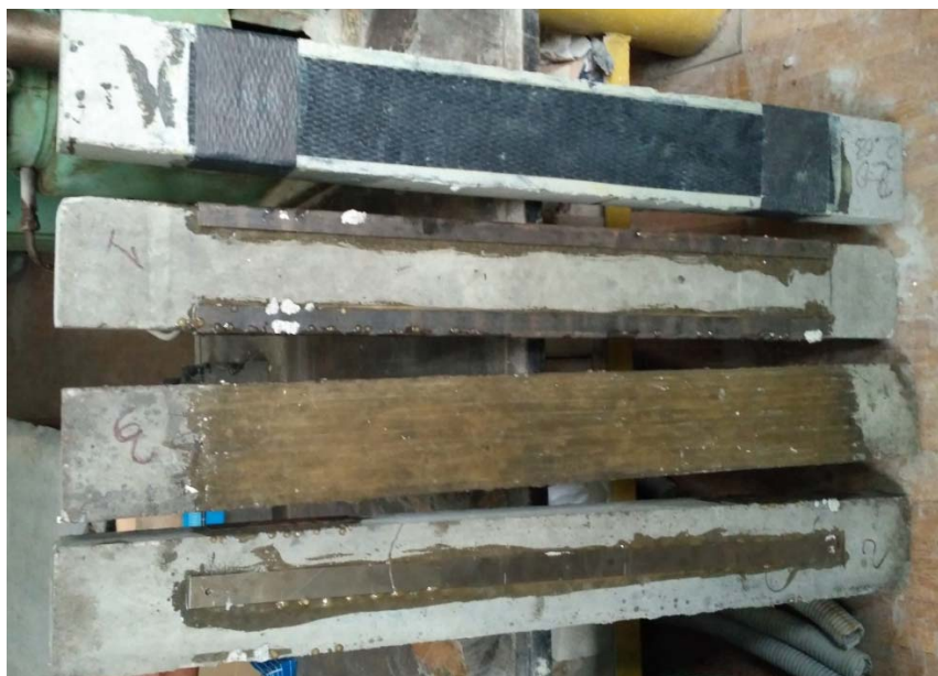
Рис. 5. Підсилення балок наведеними варіантами зовнішнього армування
