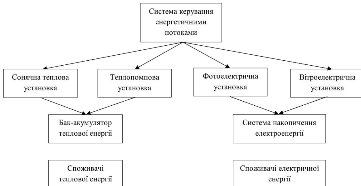
Рис. 1. Структурна схема системи комплексного енергозабезпечення об'єктів цивільного будівництва
