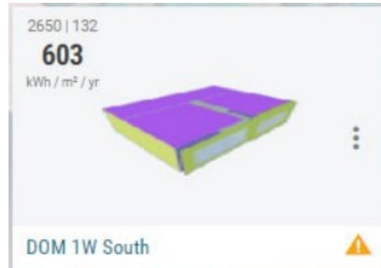
Рис. 3. Модель будинку з вітражними вікнами (одинарне скління, одна рама) орієнтованою на південь
