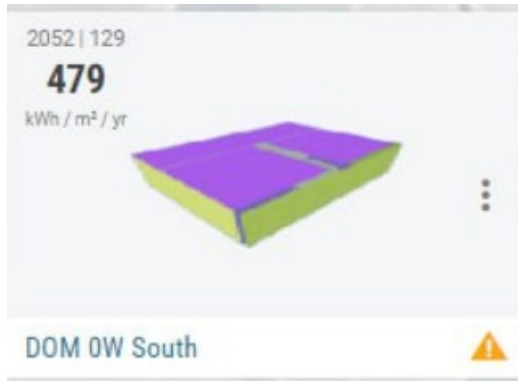
Рис. 2. Модель будинку з цільною стіною без вікон орієнтованою на південь
