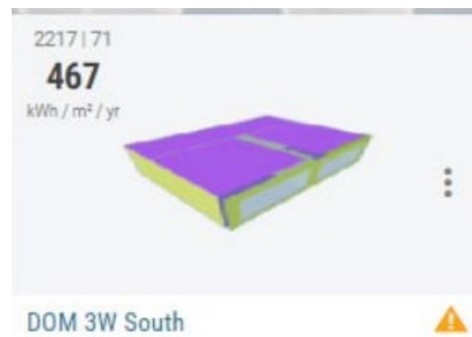
Рис. 5. Модель будинку з вітражними вікнами (одинарне скління, дві рами) орієнтованою на південь
