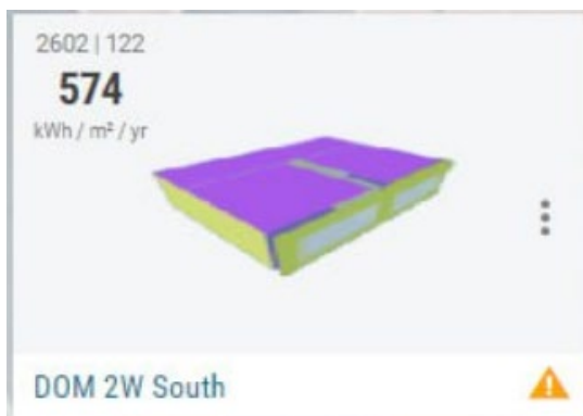
Рис. 4. Модель будинку з вітражними вікнами (одинарне скління, дві рами) орієнтованою на південь
