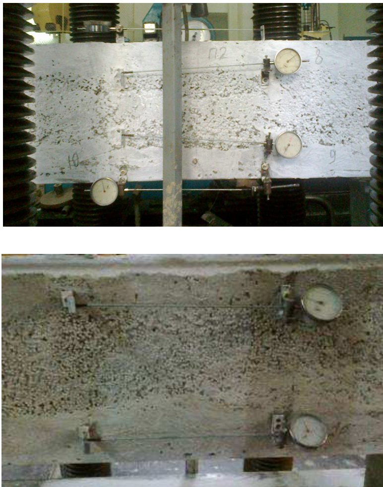
Рис.3.5. Расположение индикаторов в средней части на обеих боковых поверхностях трехслойных элементов
