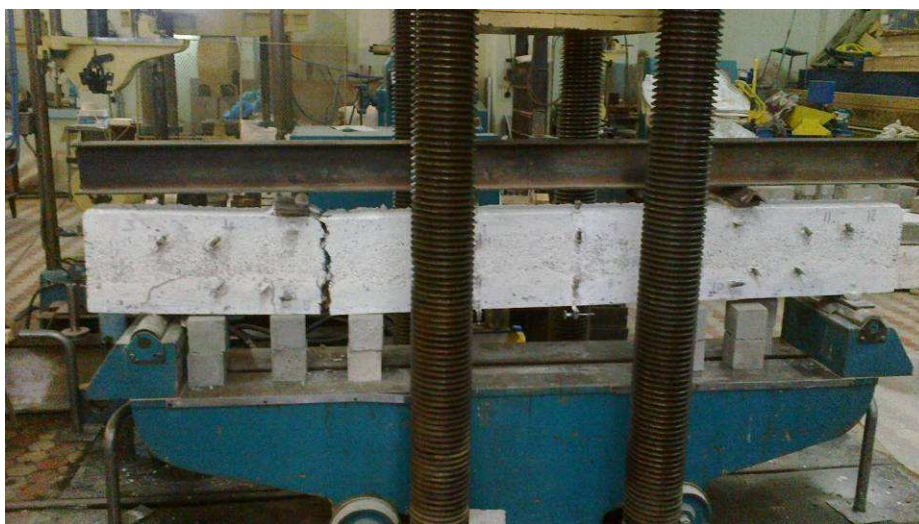
Рис.3.9. Фото балки 3-й серии после разрушения.
