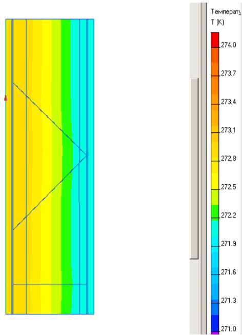
Рис.4.2. Схема распределения температурных полей полученная в программном комплексе «Elcut 5» для трехслойной конструкции с гибкими связями при разнице температур на внутренней и внешней граням в один градус
