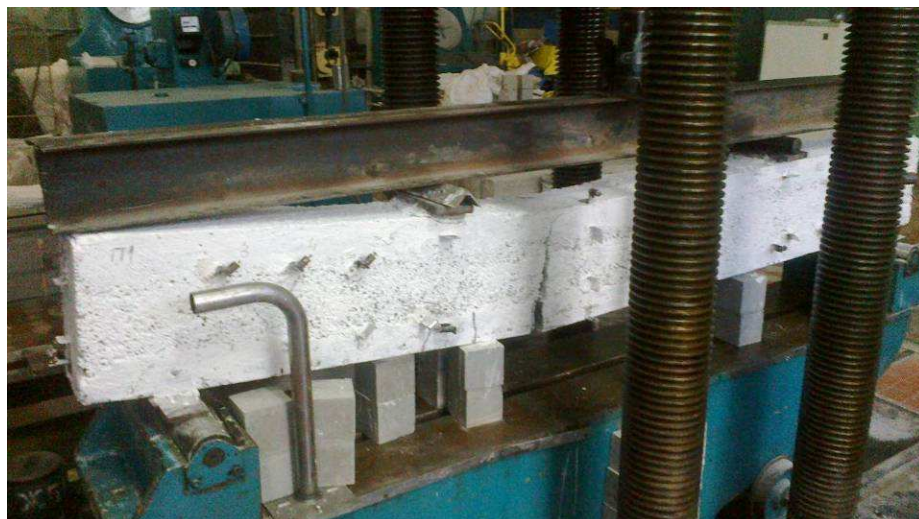
Рис.3.8. Фото балки 2-й серии после разрушения.
