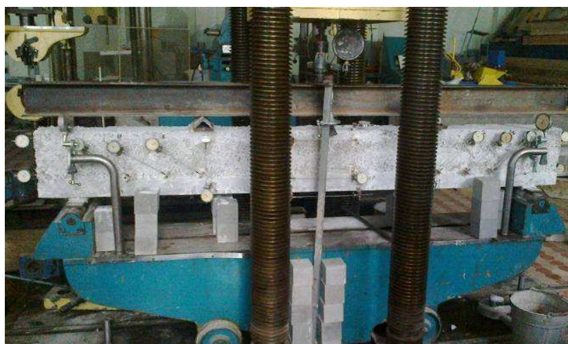
Рис.3.3. Схема (а) и общий вид (б) стенда для испытания трехслойных элементов в лабораторных условиях: 1 - балка, 2 - опоры, 3 - неподвижная тележка, 4 - страховочные стойки, 5 - силовая рама, 6 - гидродомкрат, 7 - распределительная траверса, 8 - подвижная опора, 9 - неподвижная опора, 10 - опорные пластины
