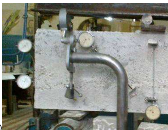
Рис.3.6. Расположение индикаторов в припорных зонах трехслойных элементов 1-й и 2-й (а), 3-й (б), 4-й (в) серий
