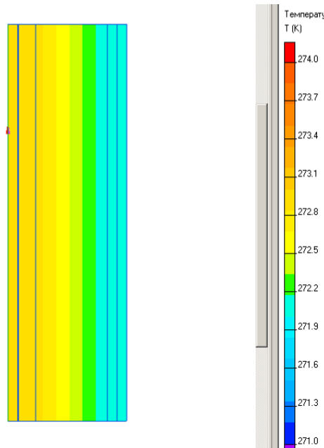
Рис.4.3. Схема распределения температурных полей полученная в программном комплексе «Elcut 5» для трехслойной конструкции с монолитной связью между слоями при разнице температур на внутренней и внешней граням в один градус
