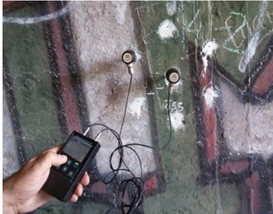
Рис. Розміщення реперних точок та вимірювання часу поширення ультразвукових коливань
