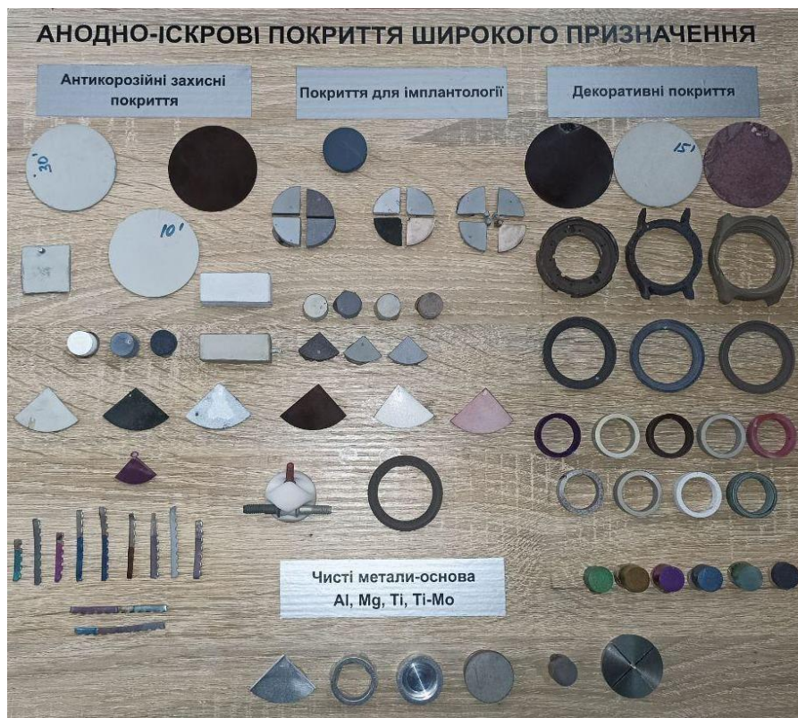
Рис. Фото покриттів, отриманих методом анодно-іскрового осадження
