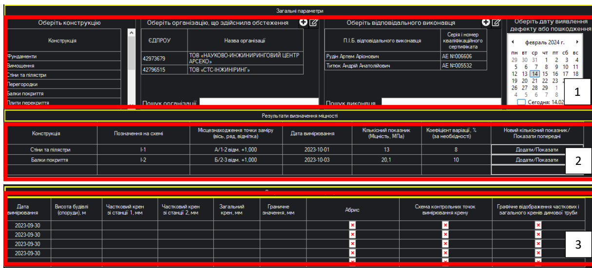
Рис. 4. Форма опрацювання результатів інструментального обстеження: 1 – блок загальних параметрів; 2 – відомість результатів визначення міцності конструкцій; 3 – відомість результатів визначення крену будівлі
