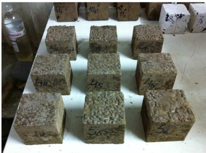
*Рис. 3. Общий вид образцов на вяжущем из глиноземистого цемента*
