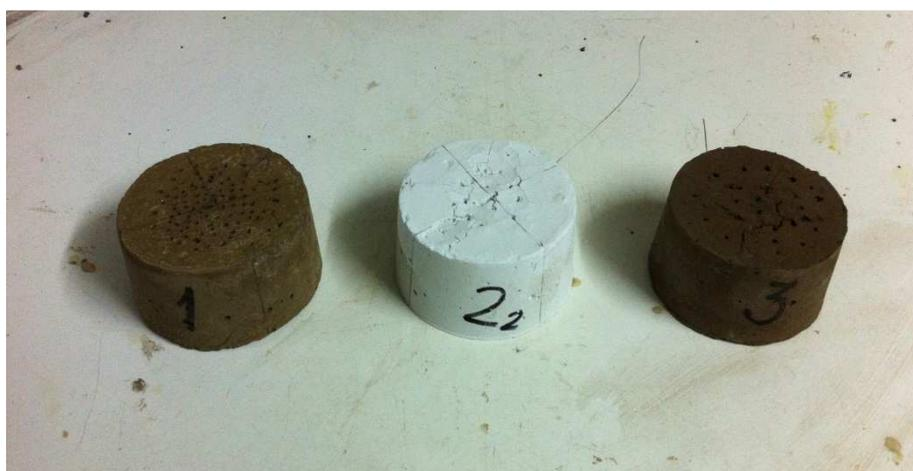
*Рис. 2. Общий вид образцов после испытаний по определению сроков схватывания цементного теста: 1 – на вяжущем из глиноземистого цемента; 2 – на вяжущем из высокоглиноземистого цемента; 3 – на комплексном вяжущем из глиноземистого цемента и жидкого стекла*
