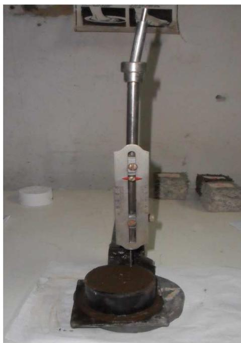
*Рис. 1. Определение сроков схватывания цементного теста*
