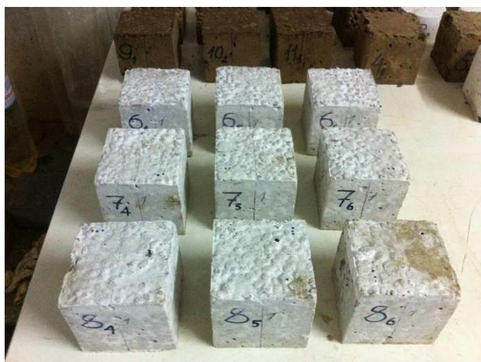
*Рис. 4. Общий вид образцов на вяжущем из высокоглиноземистого цемента*
