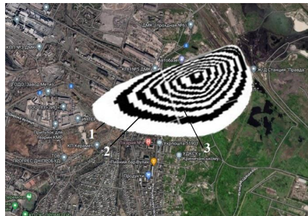
Рис. 3. Ізолінії концентрації аміаку, t = 4,7 хв: 1 – C = 0,9 г/м 3 ; 2 – C = 2,1 г/м 3 ; 3 – C = 5,4 г/м 3
