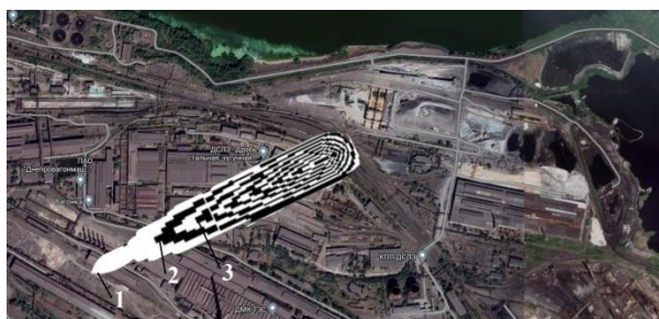
Рис. 4. Ізолнії концентрації сірчаної кислоти, t = 3,6 хв: 1 – C = 4 г/м 3 ; 2 – C = 13 г/м 3 ; 3 – C = 28 г/м 3
