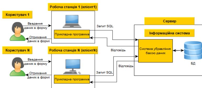
Рис. 2. Процес взаємодії користувачів з базою даних
