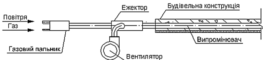
Рис. 2. Схема лінійного трубчастого нагрівача у будівельній конструкції
