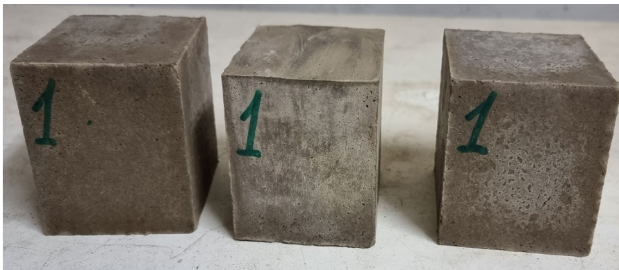
Рис. 1. Виготовлення зразків ґрунтобетону 70×70×70 (загальний вигляд) Випробування зразків кубів 70×70×70 мм. Загальний вигляд.
