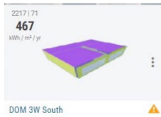
Рис. 5. Модель будинку з вітражними вікнами (одинарне скління, дві рами) орієнтованою на південь
