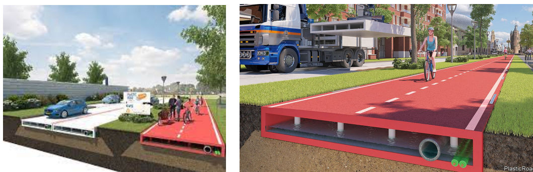
Рис. 2. Збірна, модульна, пустотіла дорожня конструкція, створена з використанням переробленого пластику "Plastic Road"
