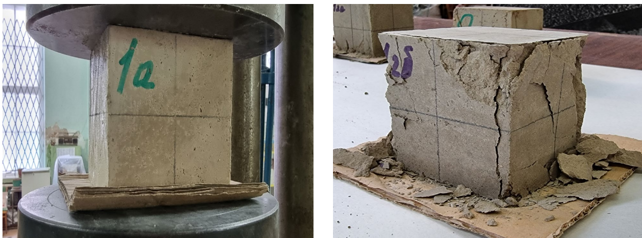
Рис. 2. Випробування зразків 70×70×70 мм, на пресі УММ-20
