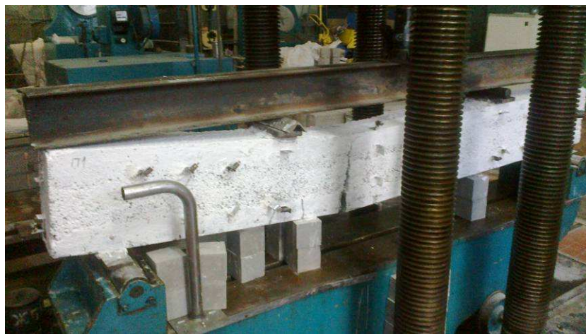
Рис. 8. Тришаровий елемент 2-ї серії після руйнування
